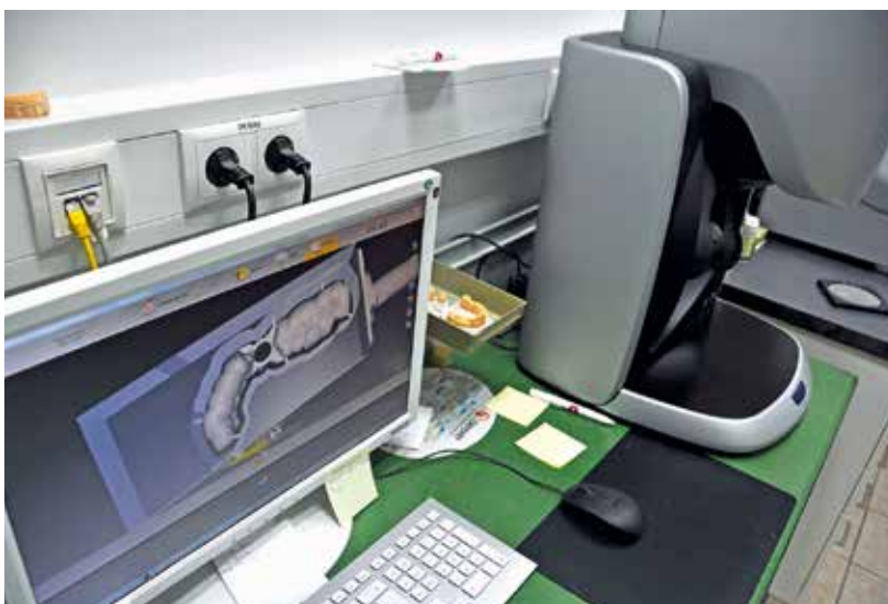
► Zahntechnischer Service für die implantologische Behandlung: erste komplett bei der Zahntechnik Jürgen Aniol selbstgefertigte „digitale“ Bohrschablone – hier die virtuelle Konstruktion ...
